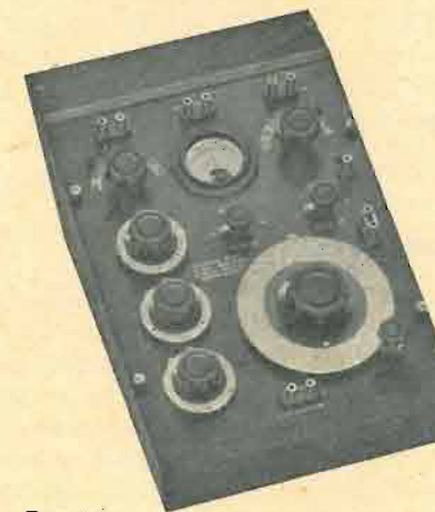
Ponte per misure di R.C.L. tipo 650-A
